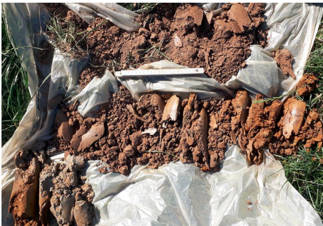
Afbeelding 2.3.3: De van links naar rechts uitgelegde boring 12. De bovenste rij is van 0-50, de middelste van 50-100 en de onderste van 100-120 cm –mv. De schaalstok is circa 23 cm lang.
