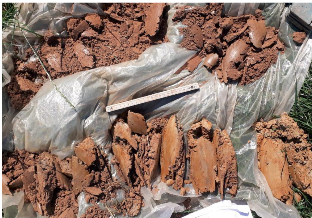
Afbeelding 2.3.4: De van links naar rechts uitgelegde boring 8. De bovenste rij is van 0-50 en de onderste van 50-120 cm – mv (met een tussenruimte bij 100 cm –mv). De schaalstok is circa 23 cm lang.
