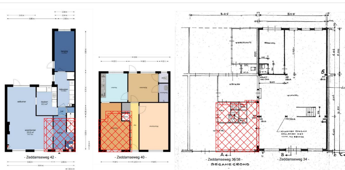
Afbeelding 29: Funderingstekening van de bebouwing met de aanwezige kelders binnen de rode arcering. De kelders zijn circa 2,5 meter diep. Bron: Joost Italiaander, 14-04-2023.
