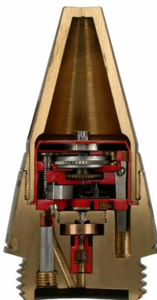
Foto 1: Dwarsdoorsnede mechanische tijdschokbuis Dopp.Z. S/60
