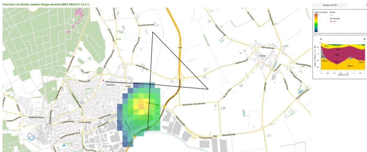
Figuur 2-4: Verspreiding kleilaag op circa NAP +8 m.
