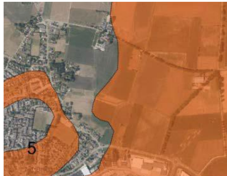
Figuur 2-6: Overzichtskaart zones geschikt voor infiltratie (niet gearceerd) en waarschijnlijk niet geschikt voor infiltratie (oranje gearceerd) Bron: Gemeente Montferland
