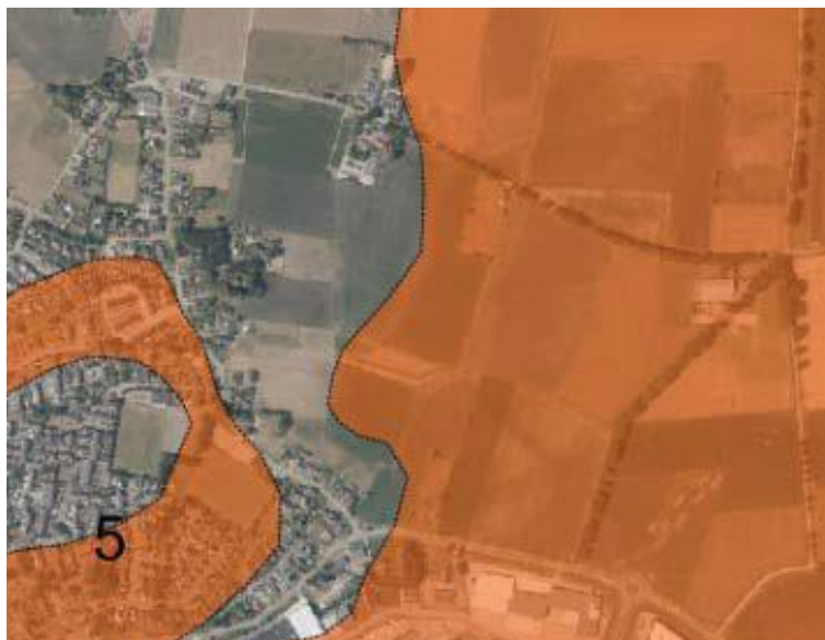
Figuur 11: Overzichtskaart zones geschikt voor infiltratie (niet gearceerd) en waarschijnlijk niet geschikt voor infiltratie (oranje gearceerd) Bron: Gemeente Montferland
