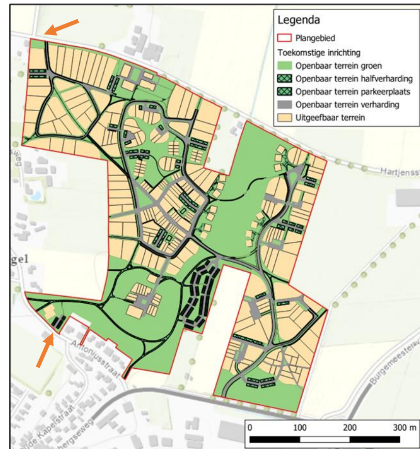
Figuur 4-5: Globale ligging aansluitlocatie vuilwaterriool
