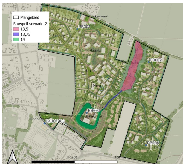
Figuur 4-1: Stuwpeil (drainage) niveaus scenario 2.
