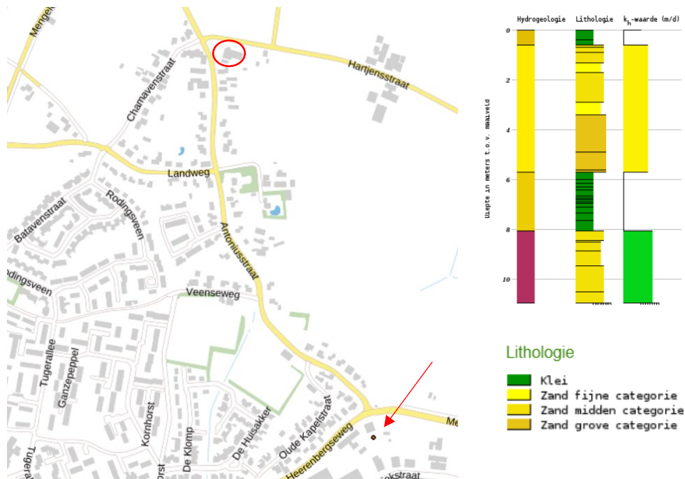
Afbeelding 2.3: Boorbeschrijving en ligging boring B40H0038 (bron: Dinoloket)
