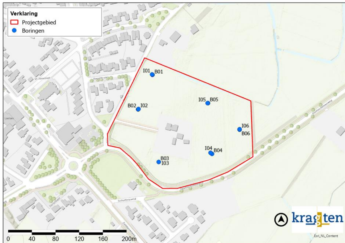
Figuur 8 locaties boringen en infiltratiemetingen
