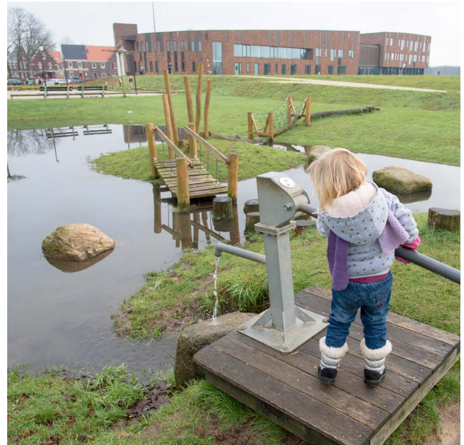
Meervoudig ruimtegebruik: wadi gecombineerd met speelvoorzieningen
