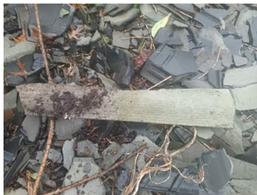
Figuur 4.1: asbestverdacht materiaal aangetroffen op het maaiveld.
