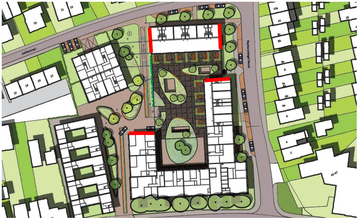
Figuur 4. Voorgestelde locaties voor het aanbrengen van meerlaagse gevelbetimmering (rode strepen) in het schetsontwerp van de toekomstige situatie.
