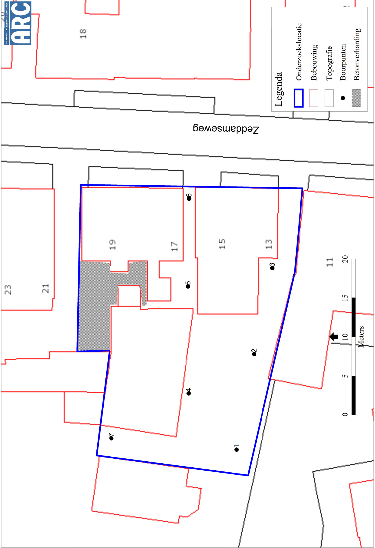
Afbeelding 7. De ligging van de boorpunten op de onderzoekslocatie. © Topografische ondergrond: GBKN, 2005-2006.
