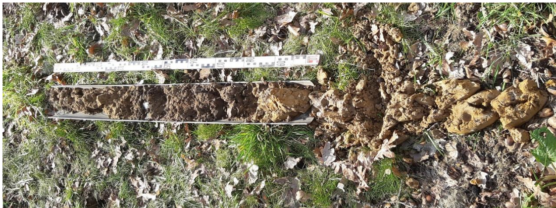
Afbeelding 15: Bodemprofiel van boring 8 ter plaatse van het clubgebouw met v.l.n.r. de donkere geroerde ophogingslagen en daaronder de gevlekte matig gerijpte oeverafzettingen (zandige klei) en het gele verspoelde dekzand.
