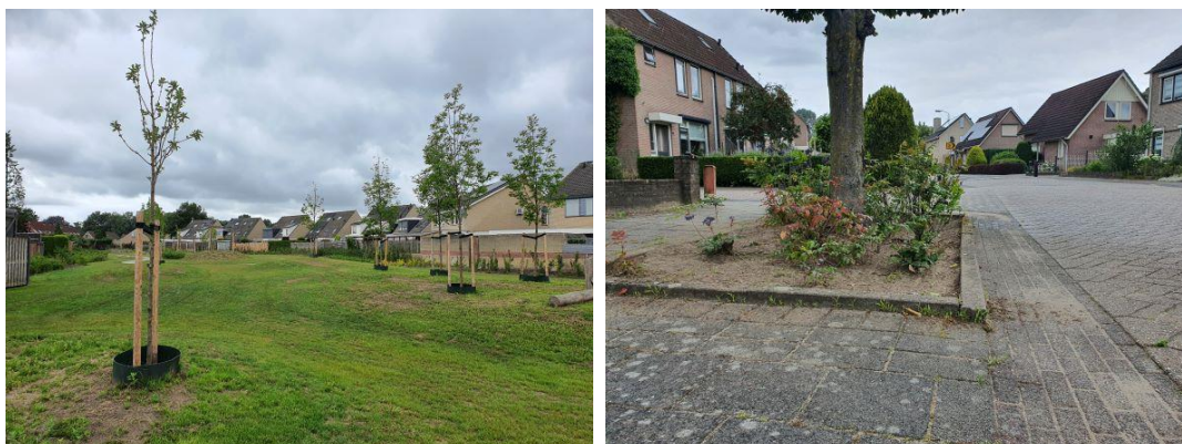
Figuur 15 Recent ingerichte speeltuin op saneringslocatie in groene middenterrein Rodingsveen (links) en straatbeeld in Rodingsveen, met weinig openbaar groen, weinig ruimte voor bergen van water en opstaande banden om de groenperken heen (waardoor er geen water instroomt) (rechts)
