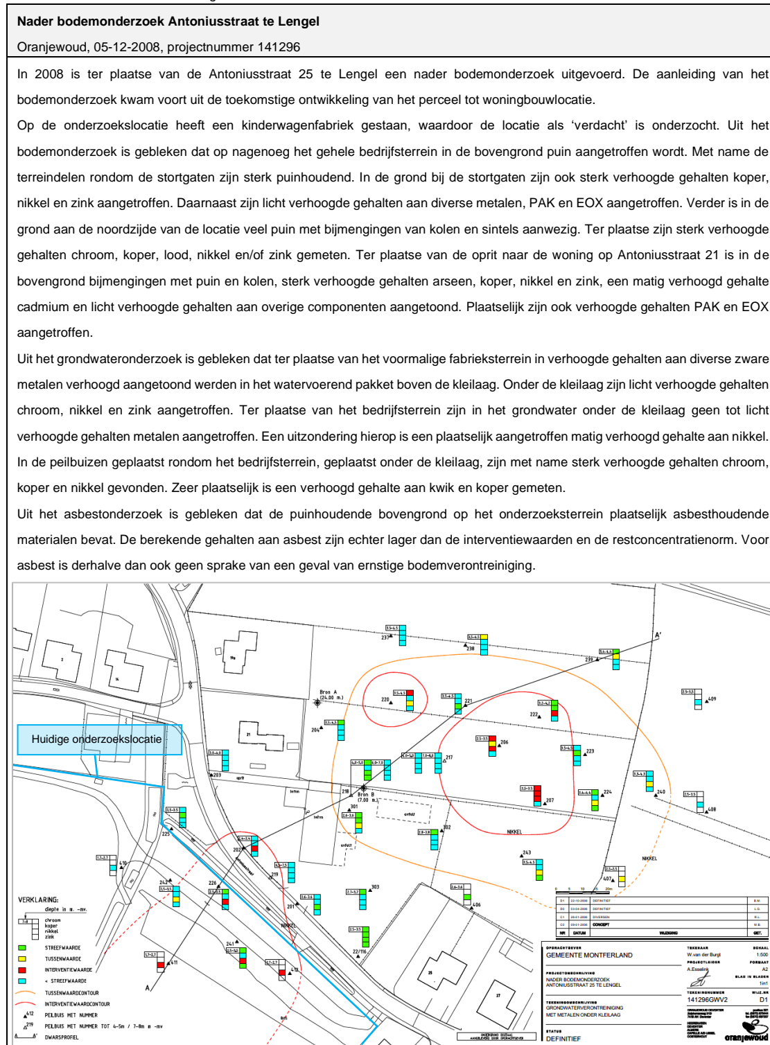
Kader 2.1: Samenvatting bodemonderzoek 2008 Antoniusstraat 25
