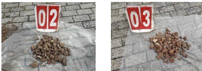
Figuur 3.1: Foto's aangetroffen menggranulaat onder verharding
