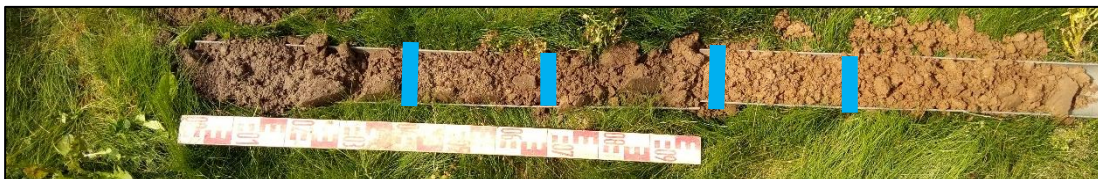
Afbeelding 13: Boring 3, met de bouwvoor, de puinlaag, de eerdlaag, de zwak ontwikkelde B-horizont en de C-horizont
