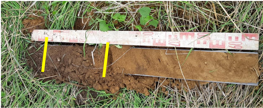
Afbeelding 11: Boring 5 met van links naar rechts de bouwvoor en de C-horizont (dekzand).
