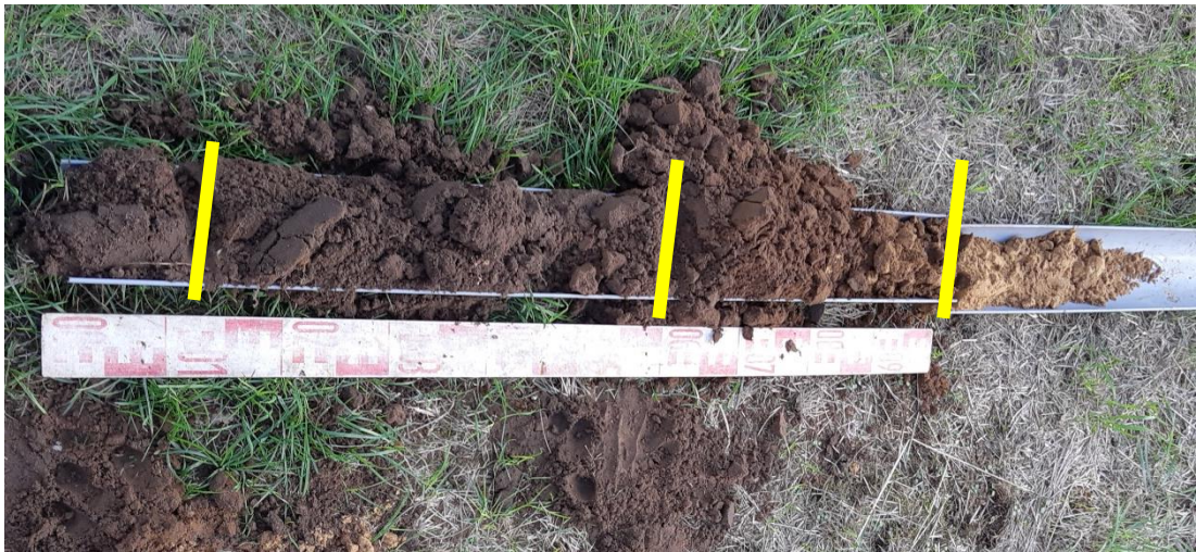
Afbeelding 12: Boring 2 met van links naar rechts de bouwvoor, de eerdlaag en de C-horizont (dekzand).
