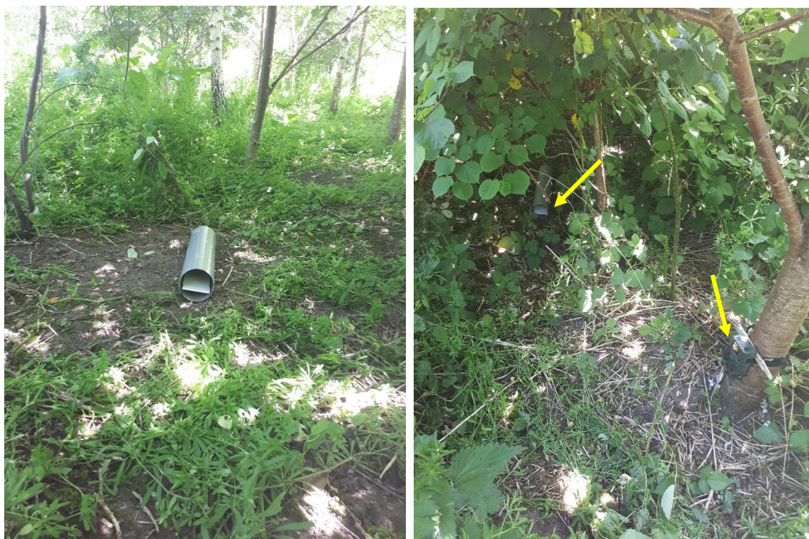
Figuur 3. Voorbeeld van een geplaatste sporenbuis (links) en van een cameraval met sporenbuis (rechts).
