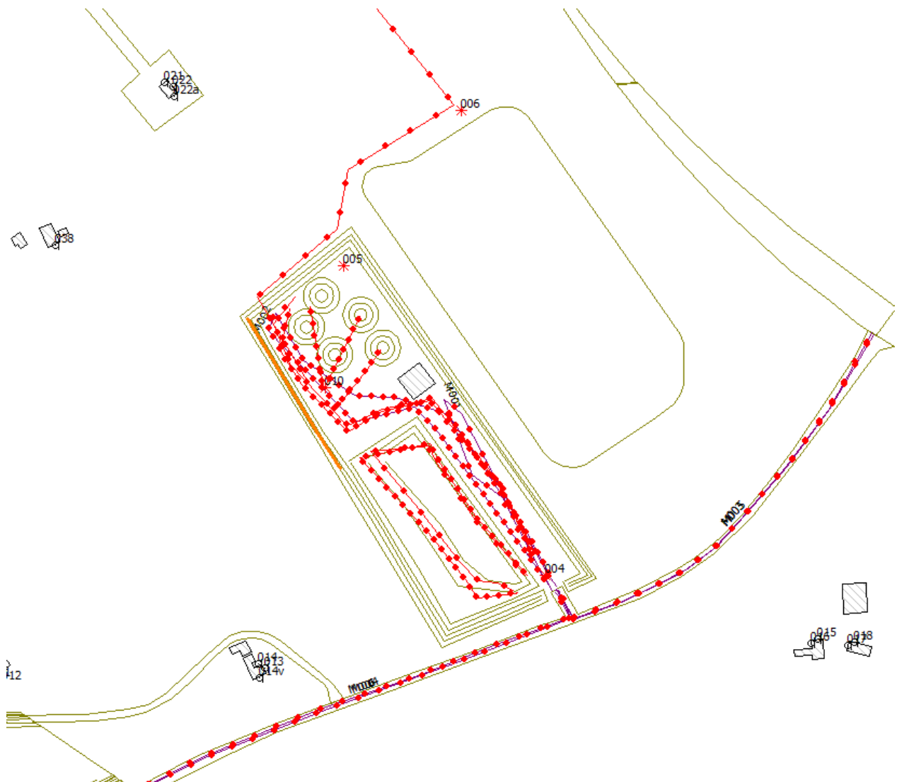
Afbeelding 9: locatie 2; scherm (oranje); hoogte 1,5 meter, lengte 150 meter.
