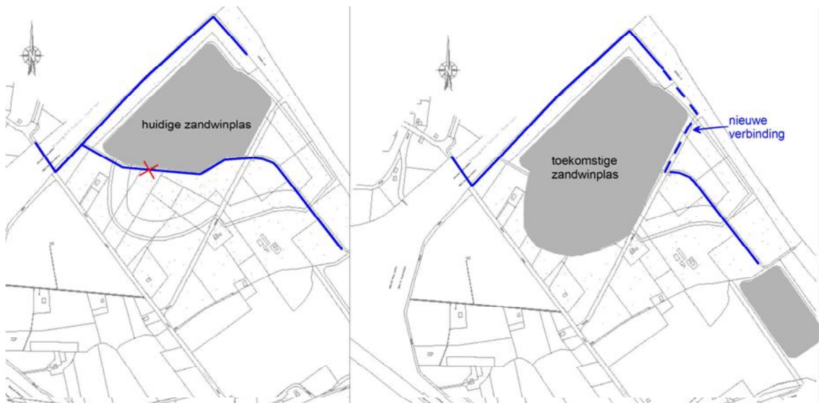
Figuur 3.5: Verlegging watergang
