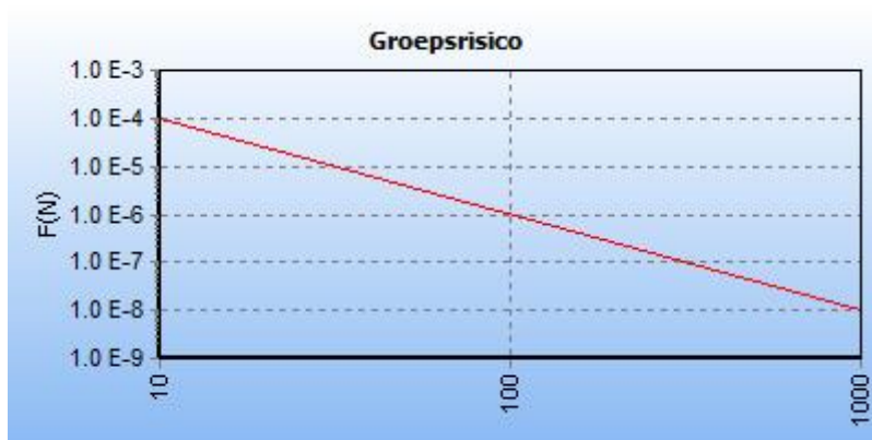
5.10 Figuur 5.10 FN curve voor 6538_leiding-N-567-28-deel-1 van N.V. Nederlandse Gasunie voor de kilometer tussen stationing 320.00 en stationing 340.00
