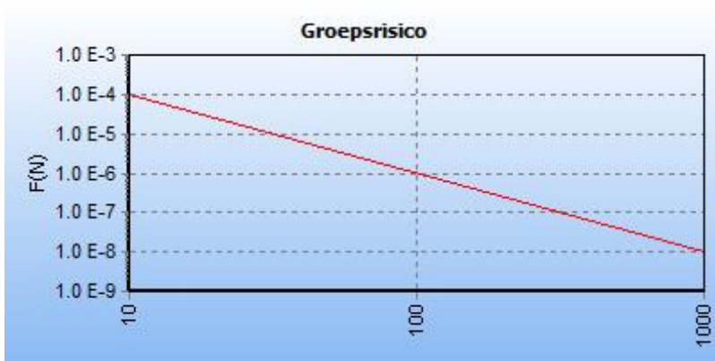
5.5 Figuur 5.5 FN curve voor 6538_leiding-N-566-03-deel-1 van N.V. Nederlandse Gasunie voor de kilometer tussen stationing 0.00 en stationing 0.00
