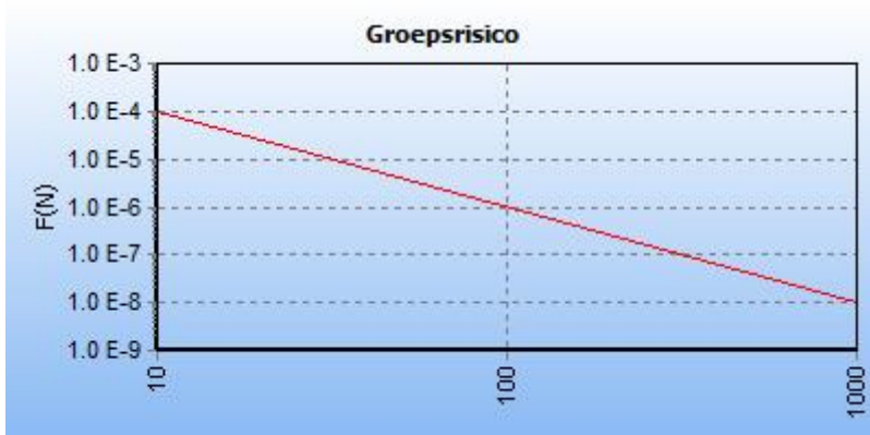
5.7 Figuur 5.7 FN curve voor 6538_leiding-N-566-11-deel-1 van N.V. Nederlandse Gasunie voor de kilometer tussen stationing 810.00 en stationing 1810.00
