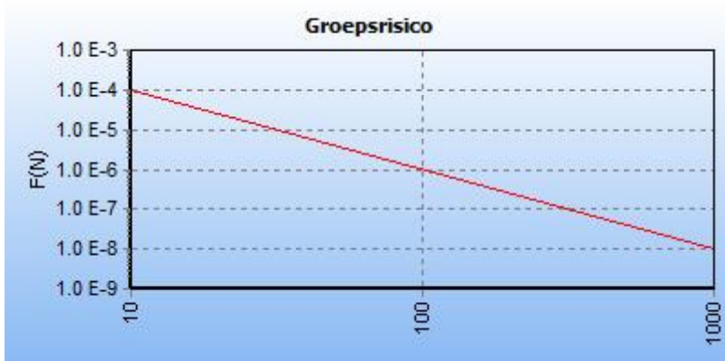
5.4 Figuur 5.4 FN curve voor 6538_leiding-N-566-02-deel-1 van N.V. Nederlandse Gasunie voor de kilometer tussen stationing 810.00 en stationing 1810.00
