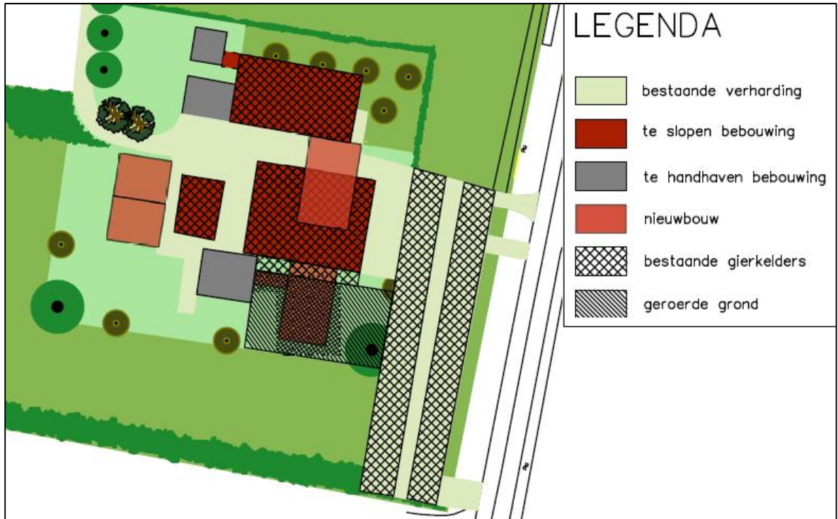
Afbeelding 1.2: Bestaande en toekomstige bebouwing, verharding, kelders en geroerde grond binnen het plangebied (Bron: informatie verstrekt door opdrachtgever).
