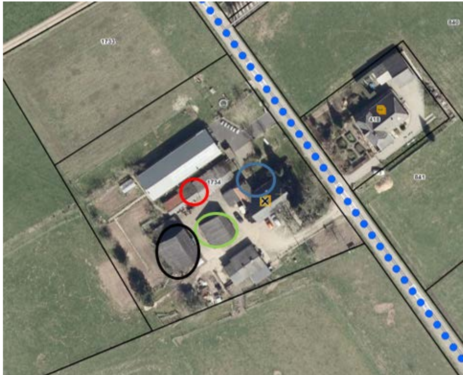
Figuur 2.1 Overzicht locatie; zwart is de werktuigenstalling, groen is de werkplaats, rood geeft de ligging van de bovengrondse dieselloletank en blauw geeft de ligging van de bovengrondse huisbrandolie tank
