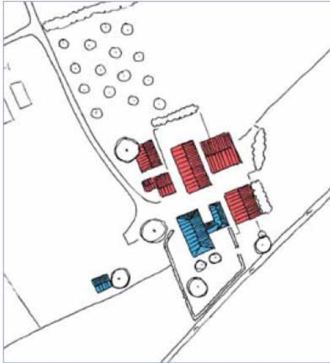
Bestaande situatie met de te slopen (rood) en te behouden (blauw) bebouwing
