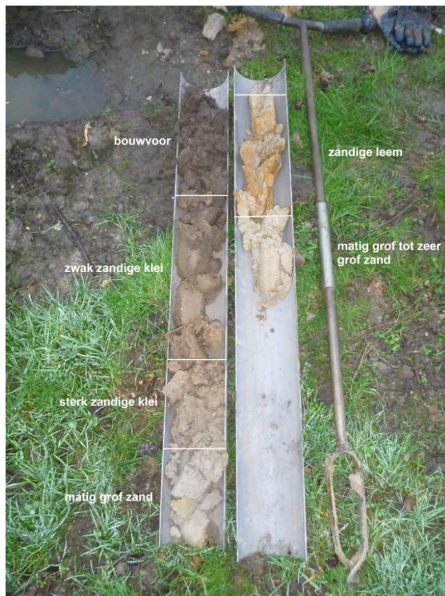
Fig. 3.2: Opgeboorde sediment van boring 6.
