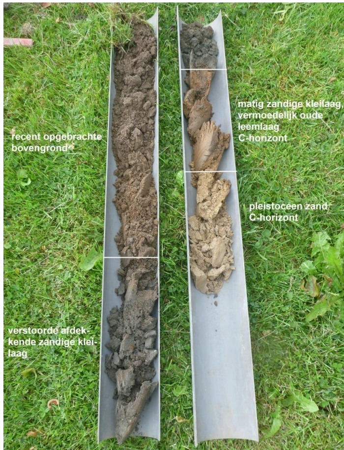
Fig. 2.2: Opgeboorde sediment van boring 22.
