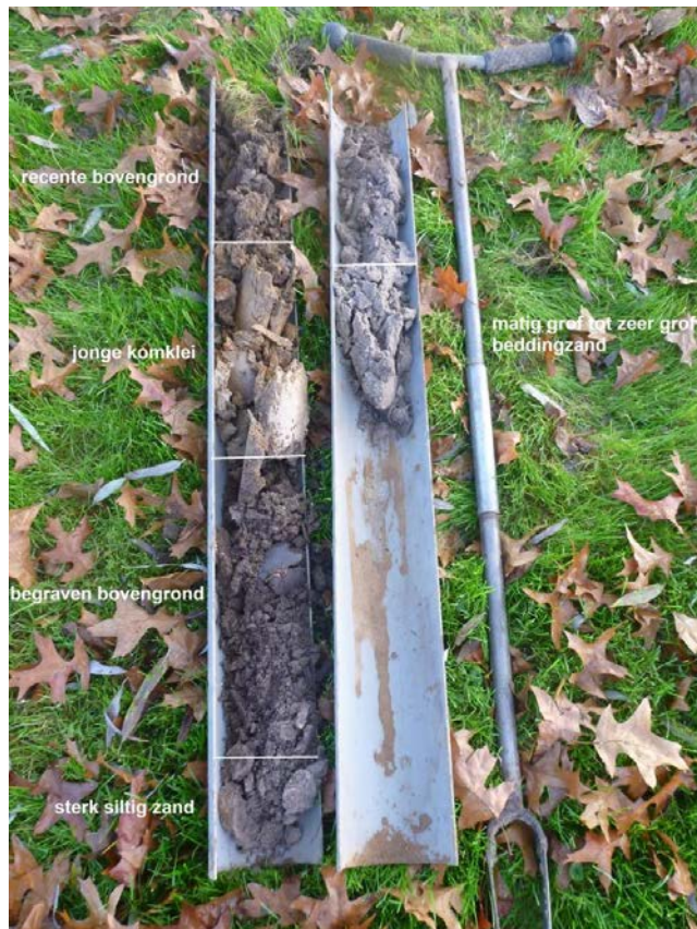
Fig. 3.1: Opgeboorde sediment van boring 12.
