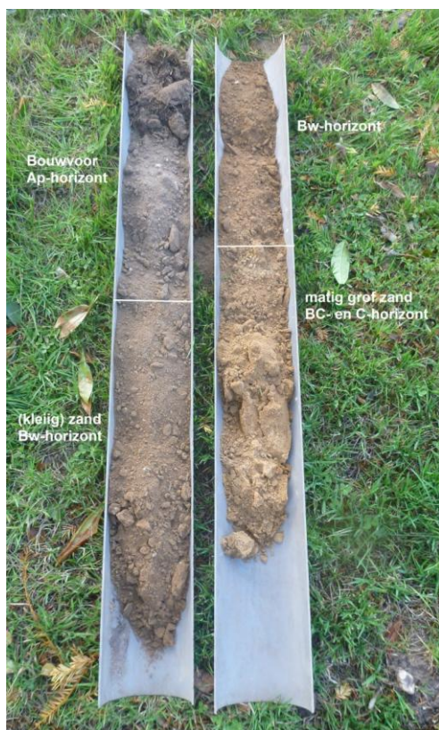
Fig. 2.1: Opgeboorde sediment van boring 18.
