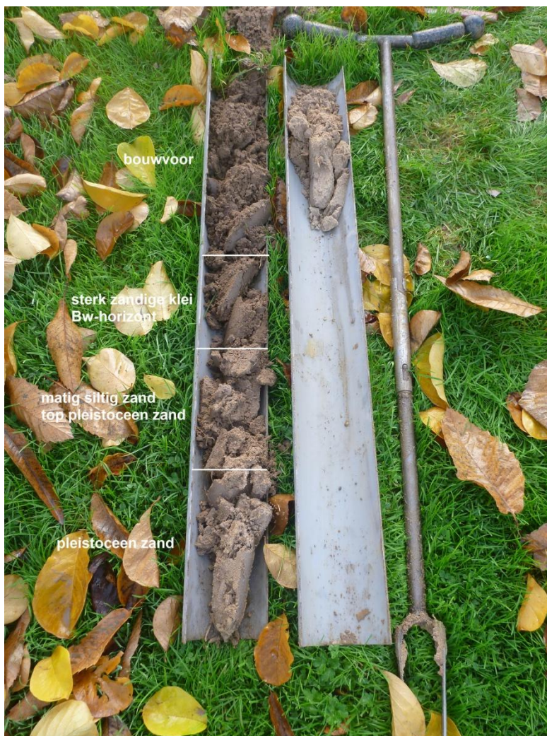
Fig. 3.3: Opgeboorde sediment van boring 9.
